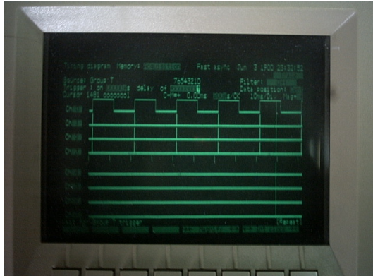
図 7 INtime スレッドの正確な波形
