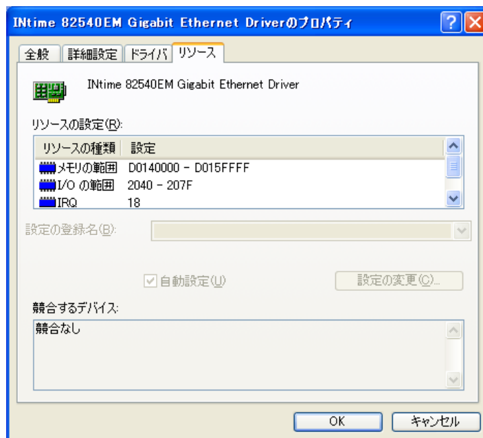
図 3 ①[82540EM Gigabit] INtime RTDRM.SYS ドライバの適用
